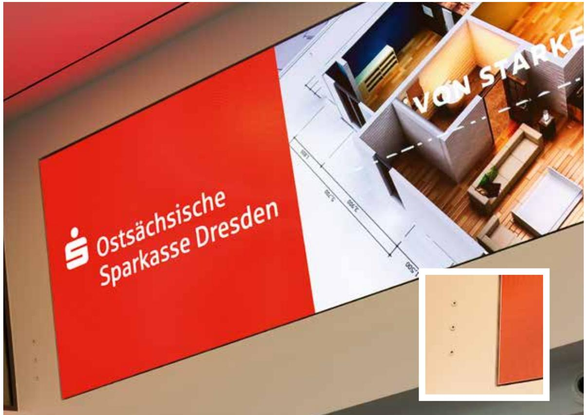
Drei Sensoren messen die Helligkeitsstufen im Lauf des Tages und passen die Helligkeit der LED-Wand dem Umgebungslicht an.
