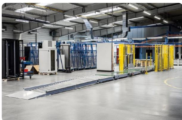
Montagelinie für Standverteiler
