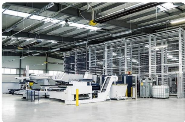
Kombinierte Laser- und Stanzmaschine
