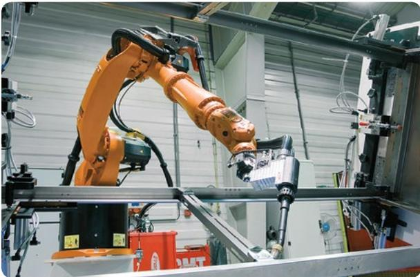
Schweißroboter für Standverteiler
