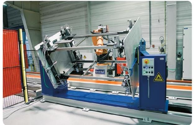
Schweißroboter für Standverteiler
