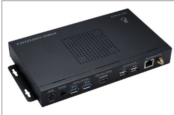
Auf der Rückseite gibt es nur eine einzige Bedientaste neben den Anschlüssen für Stromversorgung, HDMI, USB-A, RJ 45 und WiFi-Antenne.
